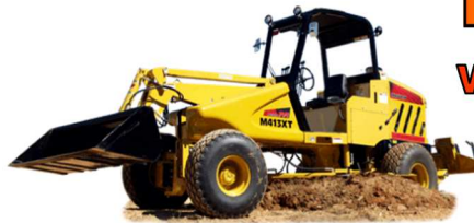
Niveleuse Mauldin modèle M413XT Lame de 10' godet 3/4 verge et scarifieur
