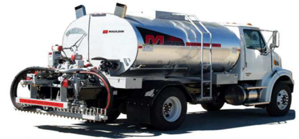
Distributeur à bitume de 1000 à 3500gl Barre d'arrosage 16' télescopique Pompe distributrice chauffée
