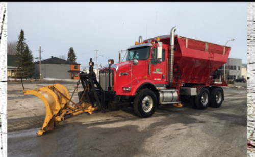
Camion à neige Kenworth T800 2011 Essieux 16/46, 18 vitesses, Caterpillar C13 suspension rubber block
