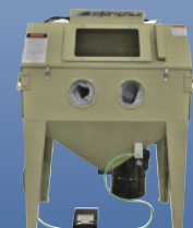
Cabinet CLEMCO Shop-Mate à succion, avec pédale d'activation, neuf ou usagé
