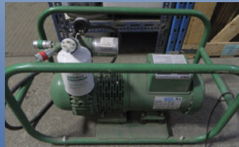
Pompe à air respirable EDP-16, électrique, 2 opérateurs, moteur 110 volts/220 volts
