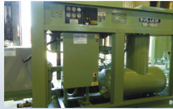
Compresseur SULLAIR, 50 hp, 575 volts, 220 CFM, 115/125 PSI
