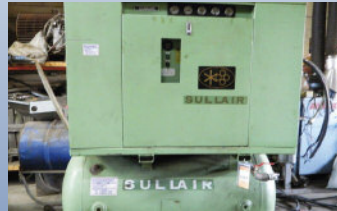
Compresseur SULLAIR, 25 hp
