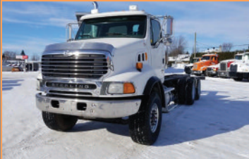
STERLING 9513 2007 , Mercedes 450 hp, 8 LL, essieux 20/46, "Full Lock", suspension à air, cadre long et double
