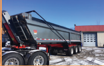
Remorque ACNS 2014 , 3 ess., suspension à air, boîte en T1, toile électrique
