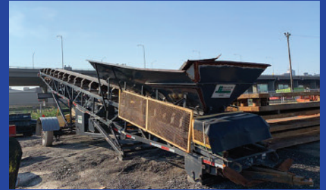
Convoyeur MGR 2015, longueur 50', moteur Perkins 4 cylindres
